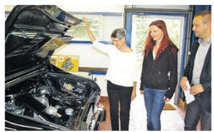
Ein Blick in den Motorraum des Tatra T 613. Bei diesem Fahrzeug war der Motor kein richtiger Heckmotor mehr, die Konstrukteure hatte ihn mehr in Richtung Mitte des Autos versetzt.
